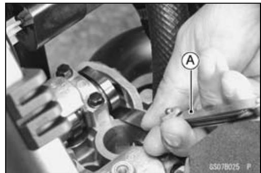
**Jeu des soupapes : entre la came et le poussoir de soupape**
